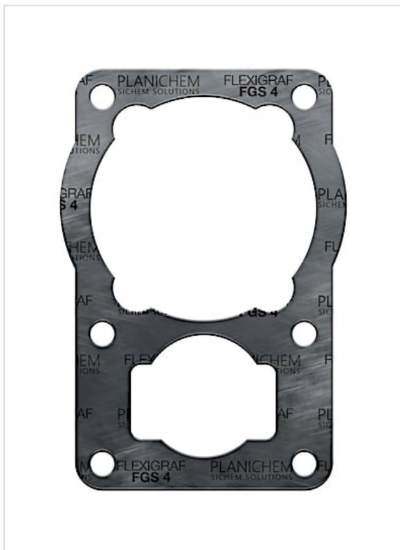
**FLEXIGRAF FGS4** è una lastra per guarnizioni piane in pura grafite minerale espansa, rinforzata con un inserto lamina liscio in acciaio inox AISI 316L. La composizione a base di pura grafite, rinforzata dall'acciaio, ha maggior grip nella tenuta, resistenza meccanica e duttilità. Ideale per l'utilizzo con vapori saturi ad alta temperatura, agenti chimici aggressivi purché in ambienti non ossidanti.
