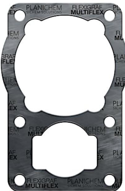
**FLEXIGRAF® MULTIFLEX** è una lastra multistrato per guarnizioni piane in pura grafite minerale espansa, rinforzata con un inserto lamina liscio in acciaio inox AISI 316L. La composizione a base di pura grafite, rinforzata dall'acciaio con disposizione multistrato, rende queste lastre per guarnizioni piane idonee per condizioni di esercizio gravose. Ideale per l'utilizzo con vapori saturi ad alta temperatura e pressione, agenti chimici e fluidi aggressivi, purché in ambienti non ossidanti.
